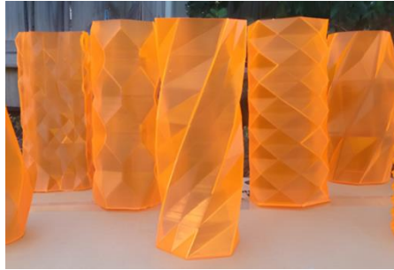
Şekil 3.6: PETG kullanılarak üretilen 3D parça örneği
