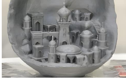
Şekil 3.2: PLA kullanılarak üretilen parça örneği
