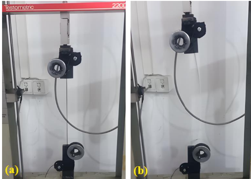
Şekil 6.23: CE1200/TPU ipin (a) test anı ve (b) kopma anı
