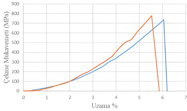
Şekil 6.42: Kaynak bölgesinin kayma mukavemeti–uzama (%) eğrileri (CE1200/PLA)
