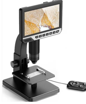
Şekil 5.9: Optik görüntülemelerde kullanılan dijital mikroskop
